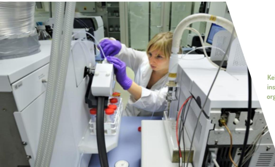
**Kelly Peeters** pri pripravi instrumenta za določitev organoskitrovih spojin.
