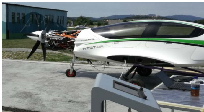
Testiranje hibridnega pogonskega sklopa ultralahkega letala
